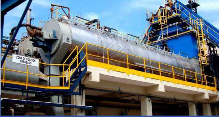
DISEÑO, FABRICACIÓN Y MONTAJE DE COCEDOR DE 50 t MATERIA PRIMA POR HORA – INDIRECTO, CON DESCARGA DE PESCADO SUPERIOR, TRANSMISIÓN, PURGAS PARA AIRE AUTOMÁTICA, MANIFOLD PARA VAPOR, PLATAFORMA DE MANTENIMIENTO, TAPAS CON CONTRAPESO, HÉLICE SIN DESCANSO CENTRAL EN "V" CON PLATINA EN EL EXTREMO, CHAQUETA CON VAPOR DIRECTO Y CON APROVECHAMIENTO DE REVAPORIZADO DE LA HÉLICE.
