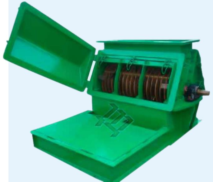
DISEÑO, FABRICACIÓN Y MONTAJE DE MOLINO SECO PARA 20 t. DE HARINA DE PESCADO SIN ASISTENCIA. MARTILLOS EN ACERO ENDURECIDO, ANTIABRASIVO, PARA USO POR AMBOS LADOS. VISTA ISOMÉTRICA. SIN INCLUIR TRANSMISIÓN, PROPORCIONADA POR EL CLIENTE.
