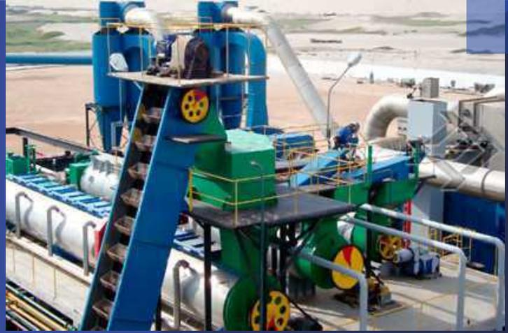
DISEÑO, FABRICACIÓN Y MONTAJE DE ELEVADOR DE CANGILONES EN ACERO INOXIDABLE 304 PARA 100 t DE CAPACIDAD Y 18 m DE LONGITUD.
