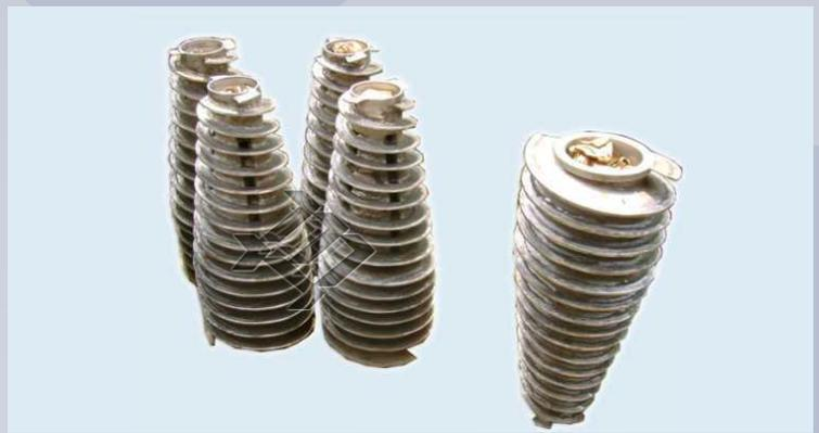
HELICOIDALES DE SEPARADORAS ANTES DEL PROCESO DE REPARACIÓN QUE INCLUYE RELLENO DE HÉLICES Y BALANCEO A VELOCIDAD DE OPERACIÓN.
